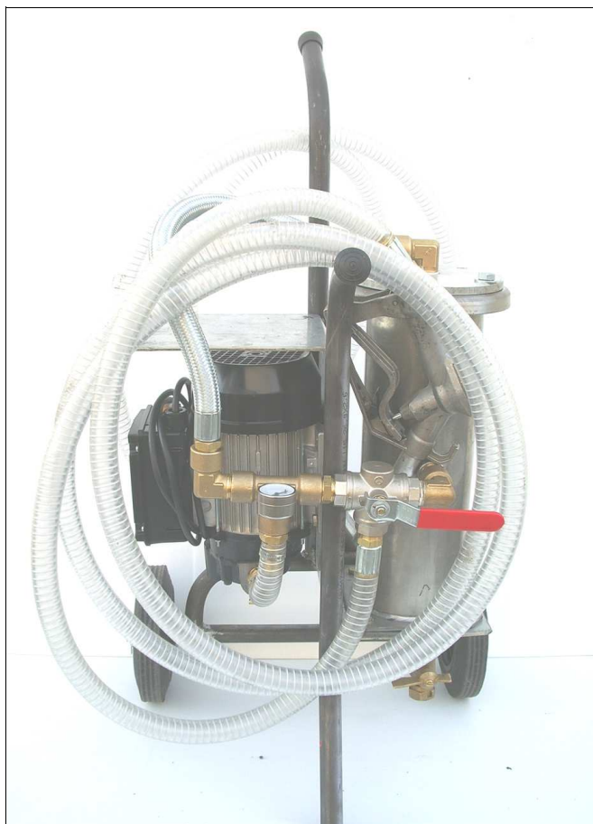
Position filtration vers cuve de stockage ou réservoir
